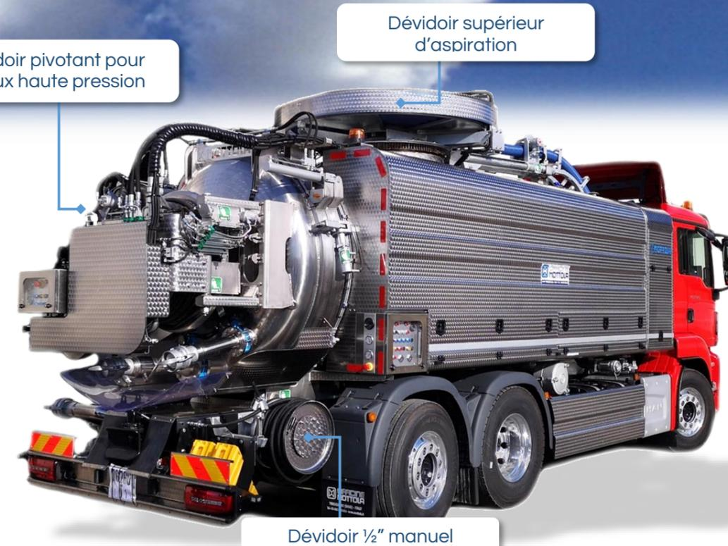
Citerne avec cloison mobile pour une séparation modulaire des compartiments eau et boue
